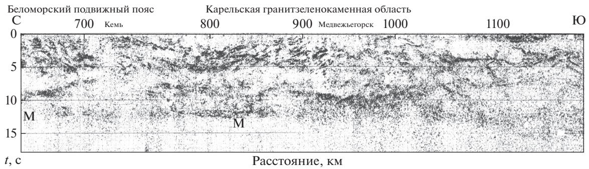
Рис. 8. Временной разрез земной коры северной части Балтийского щита по данным ОГТ, профиль 1-ЕВ (рис. 1) [Берзин и др., 2000].
